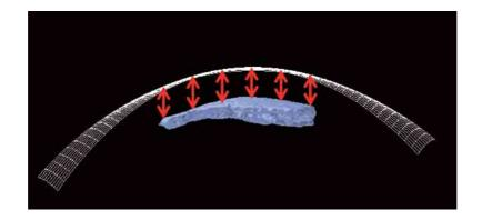
ベジェ曲面による破片表面形状の近似
