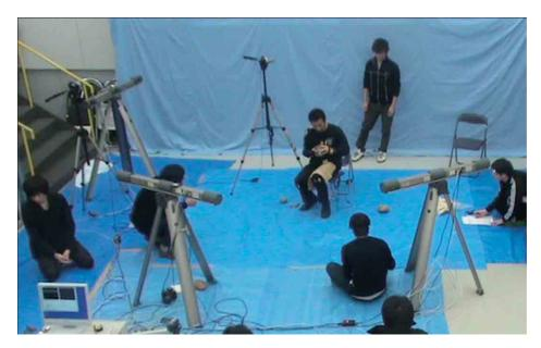
Fig.1 実験風景。石器製作を行う実験者(長井)を取り囲むように設置されているの が、今回用いたモーションキャプチャ装置(Phoenix Technologies 社、Visualeyez VZ4000)である。実験では身体動作の計測の他に、加工によって得られる剥離 片の記録とビデオによる実験者の行動・発話の記録を行った。
