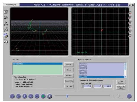
Fig.2 計測用ソフトウェアの画面。画面左上に計測したデータを3次元空間上で再構築し正面方向から表示した映像が表示されている。赤点は測定点、緑線は両腕上の測定点同士の位置関係を仮想的に接続するための接続線であり、本画像では右腕の肩から手首にかけてと左腕の肘から手首にかけての測定点同士の位置関係が再構築されている。
