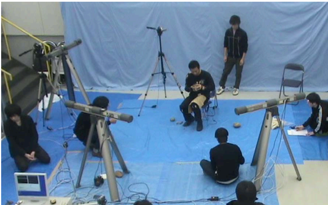
図1. 実験風景。実験者（長井）を取り囲むように設置されているのが、今回用いたモーションキャプチャ装置である。
